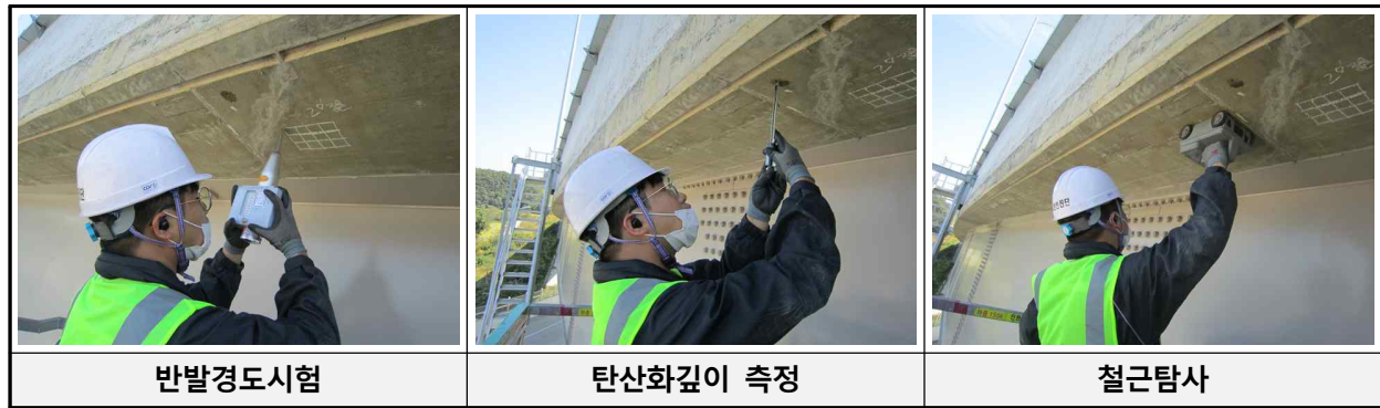
[그림 2.3.1] 비파괴시험 수행 사진
